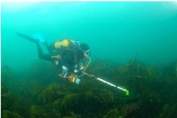
Détection par plongeur à l'aide d'un détecteur sous-marin
