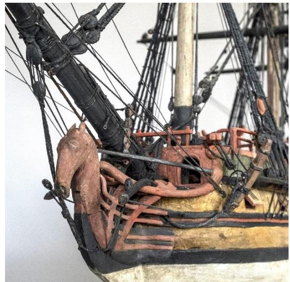
Vue de l'ensemble de la proue avec la figure du dromadaire, le mât de beaupré et l'ensemble herpes, boudin, jambettes qui s'appuient sur le dauphin et transversalement le minot.
